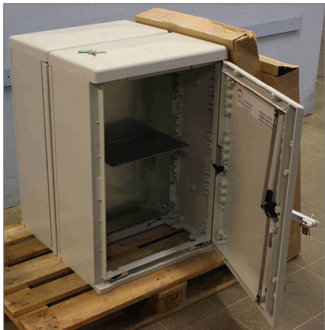
Abbildung 1: Stahlschrank für die Aufnahme von Messtechnik „im Felde“
